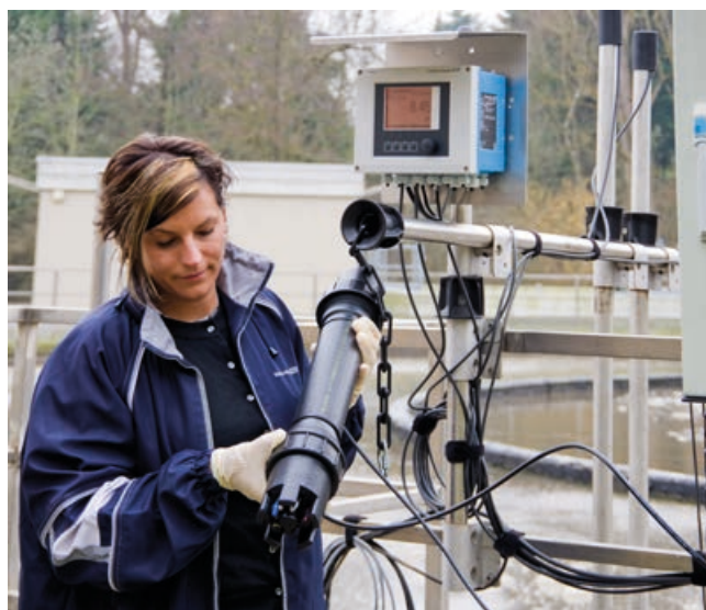
Det ion-selektive målesystem ISEmax CAS40D tilbyder hurtig og nem kontrol af processer inden for spildevandsrensning.
