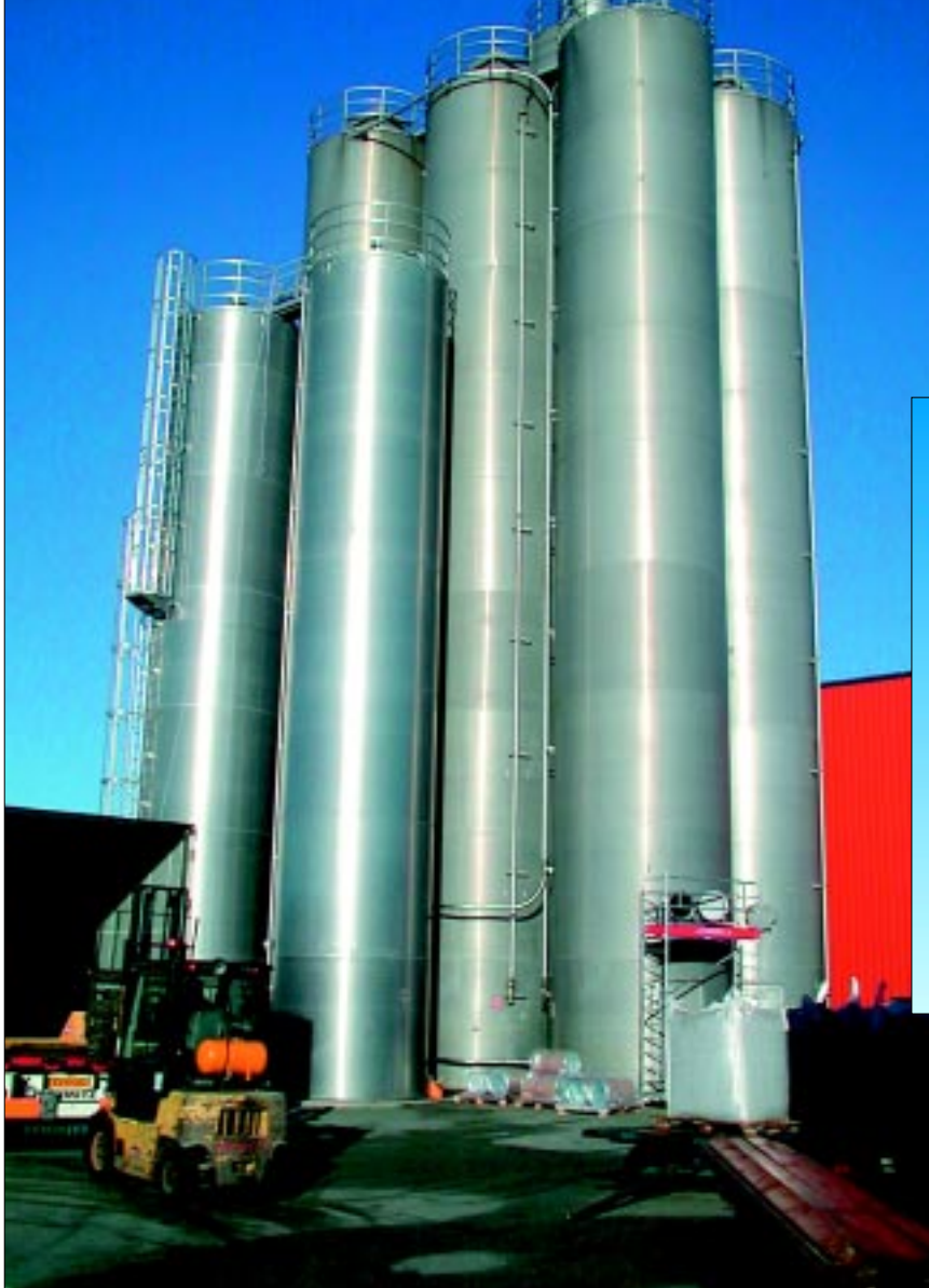
Guided microimpuls princip anvendes fx til niveaumåling i siloer med plastgranulat.
