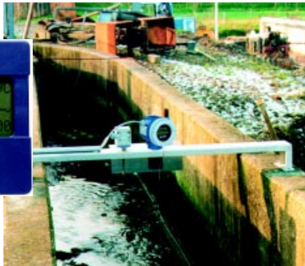
Ultralydsmålere kan benyttes til flowmåling i åbne kanaler.
