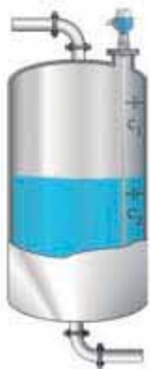
Fig. 2. Funktionsprincip - kapacitiv niveaumåling I niveaumåling benyttes en sensor, der udgør den ene "plade" i kondensatoren, som den anden "plade" benyttes som regel beholder væggen. Elektronikken justeres til en nulværdi ved udækket (eller delvis dækket) sonde og justeres til en maks-værdi ved sonden dækket til det ønskede niveau.
