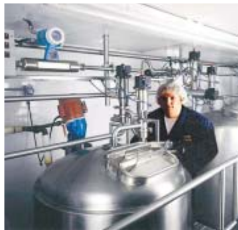
▲ Indenfor farmaceutisk industri kan Coriolis masseflowmåleren give informationer om ændringer i produktets vægtfylde.
