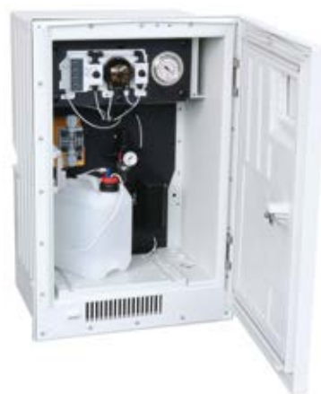
CAT 810, 820, 860 er en ny generation af prøvefiltre. Et nyt keramisk filtermateriale garanterer krystallære og bakteriefrie prøver
