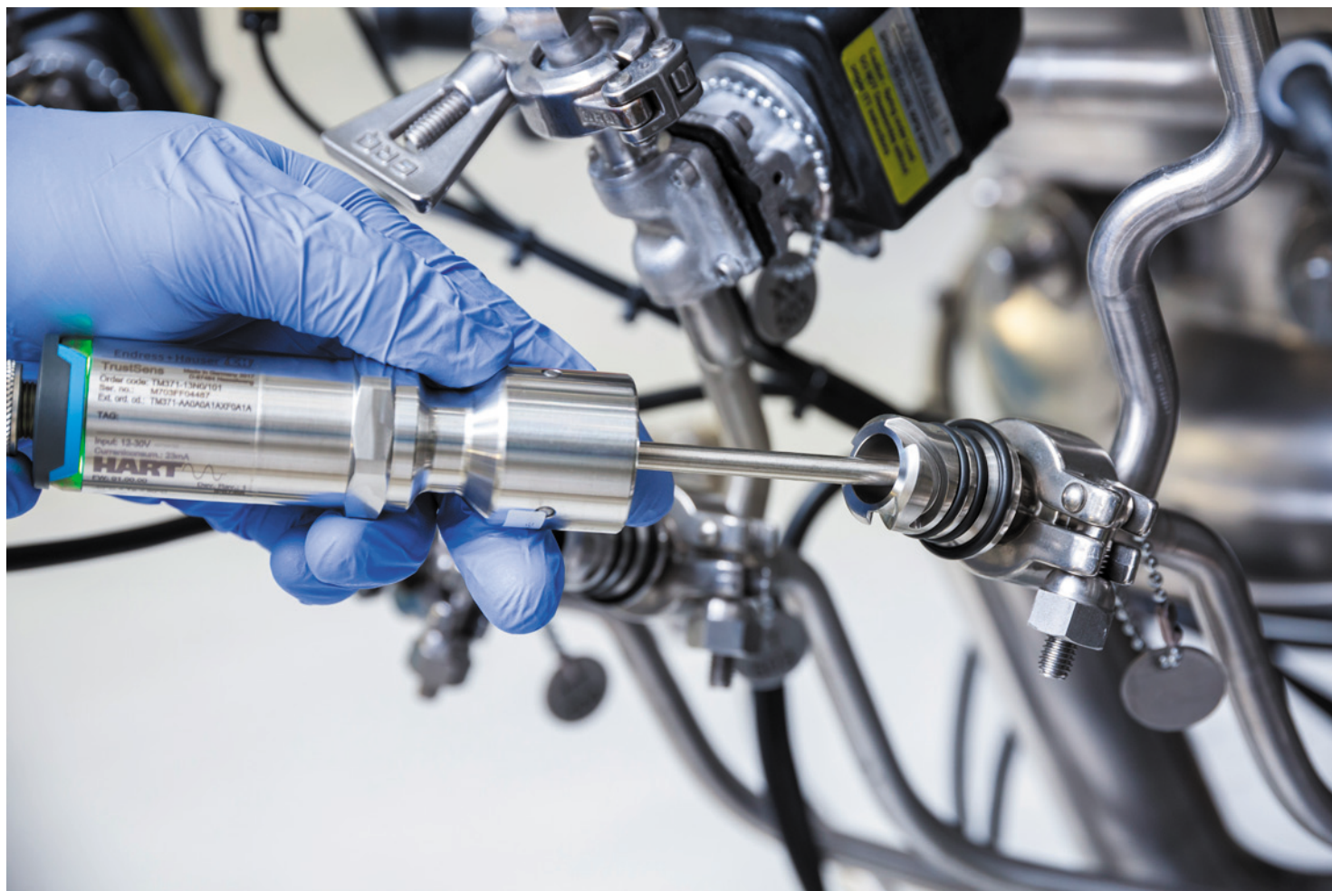
Endress+Hauser's Quick Neck gør det muligt at fjerne sensoren uden at afbryde ledningerne.
