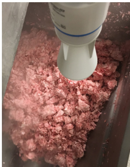
Micropilot FMR10 styrer tilførslen til den industrielle kødhakker.
