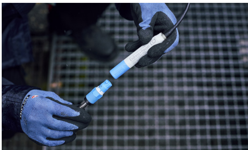
Liquiline Compact CM82 transmitter til analytiske målepunkter, hvor installationspladsen er ekstremt begrænset.
