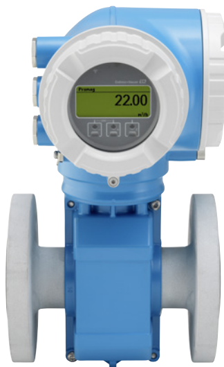
Promag W 300 – Kompakt udgave med svejsede flanger, DN 50 (2 ") og polyurethan liner.
