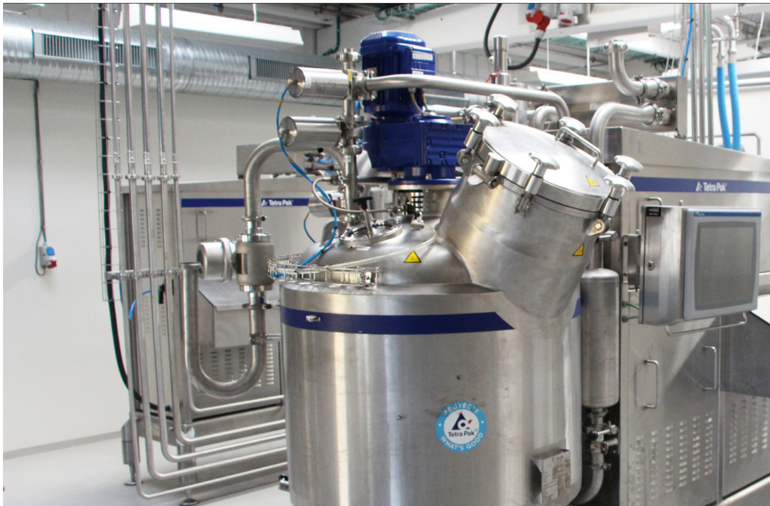
Eksempel på en af testcenterets avancerede miksere med integreret varmekappe.
