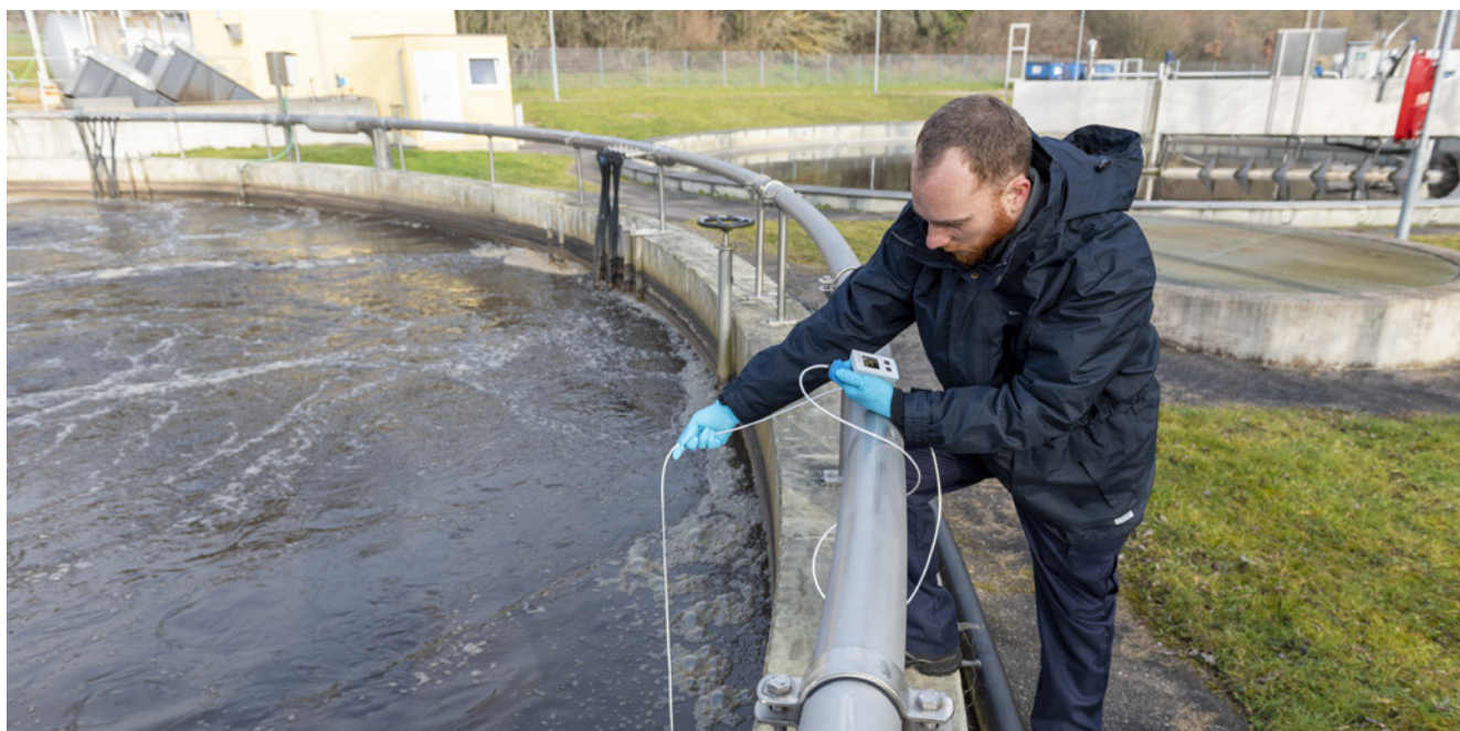
Liquiline Mobile CML18 monteret direkte med pH elektrode CPL51E.
