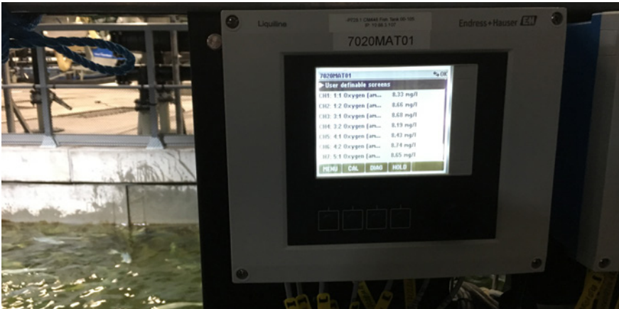
Liquiline analysetransmitter. Overvågning af iltindholdet fra otte separate iltensorer.
