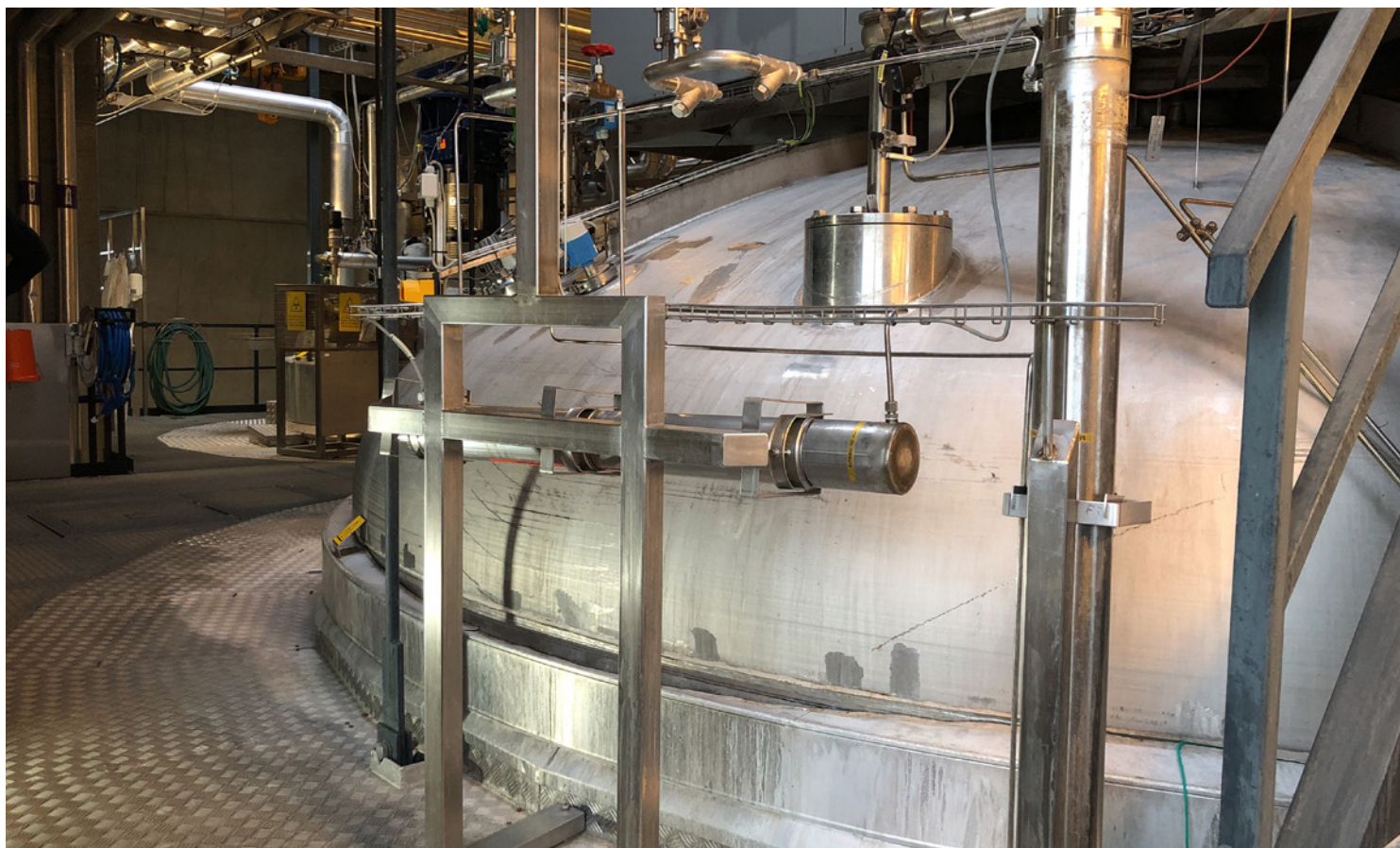
På den eksisterende detektorinstallation ses de små rørføringer, som tilfører køling.
