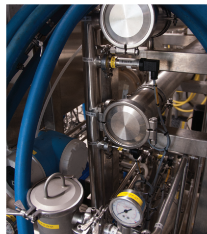
De to filtre i forsøgsanlægget kan udskiftes med forskellige membraner, så de forskellige filtreringsmetoder kan afprøves.
