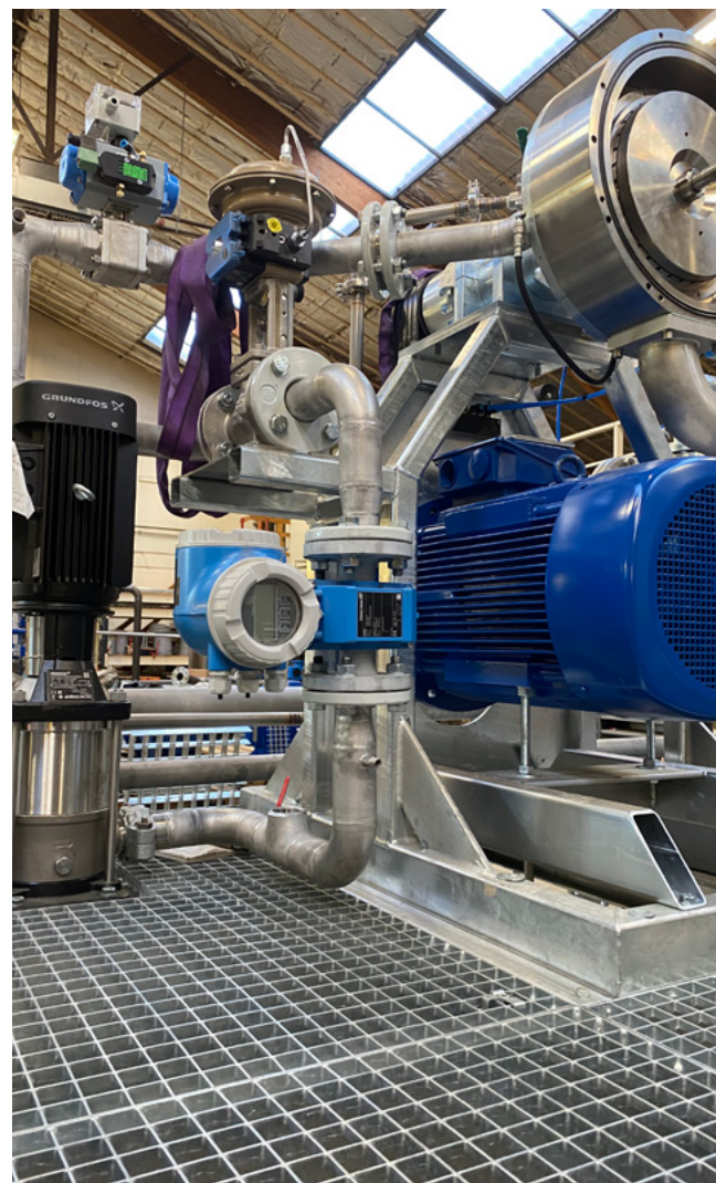
Det mekaniske hjerte i ethvert emulsionsanlæg fra ENH Engineering er den egenudviklede "Anionic/Cationic emulsions kværn".
